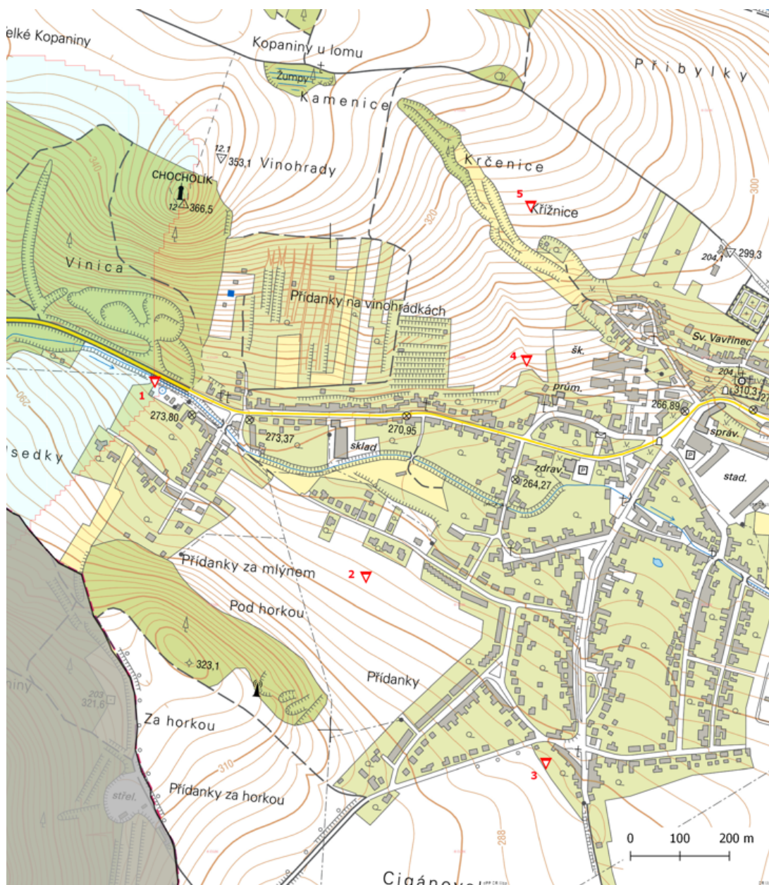
Obrázek 4: Zhodnocení vzniku přívalových povodní na území obce Drnovice metodou kritických bodů
