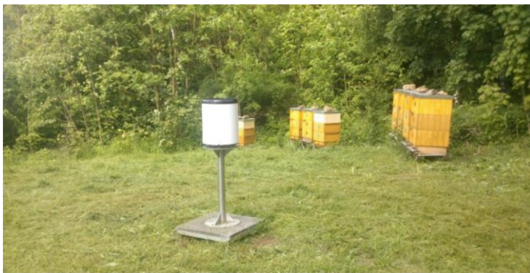
Obr. 12: Vyhřívaný srážkoměr města Vyškov umístěný v Dinoparku Vyškov
